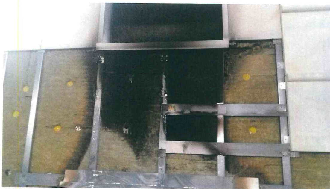
Рис. 7. Внешний вид образца после остывания со снятым слоем керамогранита.
